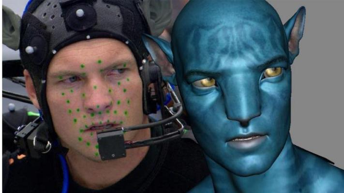
*Figura 30: Sistema óptico de marcas pasivas en la película 'Avatar'*
