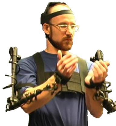
*Figura 33: Sistema mecánico de MoCap*
